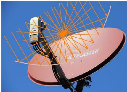
Satellitenschüsseln (Parabolantennen) haben die Form eines Paraboloids. Aus dem Unendlichen nahezu parallel eintreffende Strahlen werden an einer Parabel reflektiert und treffen sich in einem Punkt, in dem dann der Empfänger sitzt.
